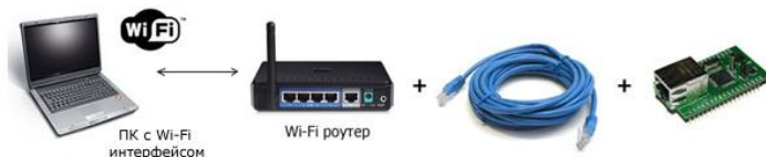
Рис.5 Схема управления модулем через сеть Wi-Fi
