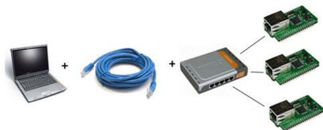
Рис. 6 Схема подключения нескольких модулей в одну сеть
