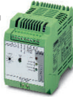
ИБП со встроенным источником питания, 100-240 В перем./пост. тока / 24 В постоянного тока, 2 А
